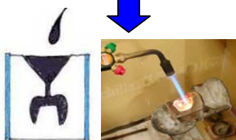
⑦蠟（ろう）を蒸発させ空洞になった石膏の中に、溶かした金属を遠心力で流し込みます。
